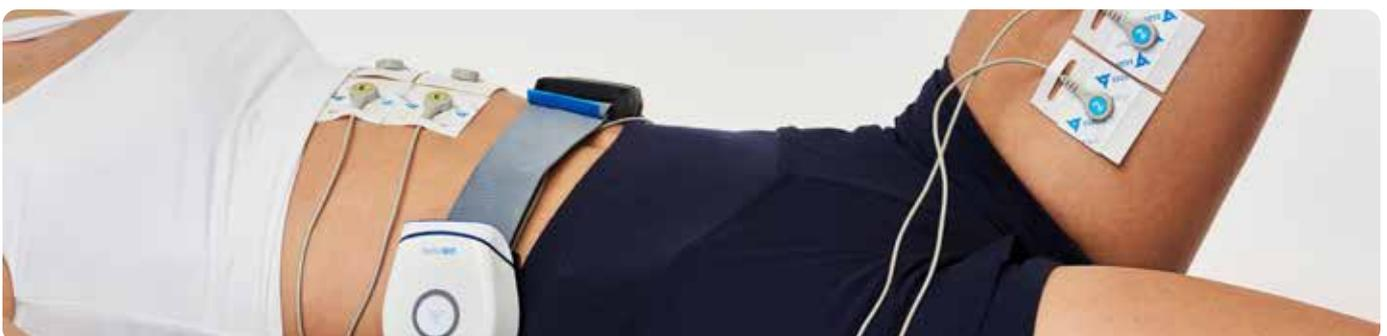
Robot riabilitativo a due motori con elettrostimolazione ed elettromiografia sincronizzate che attivano il movimento degli arti inferiori.
